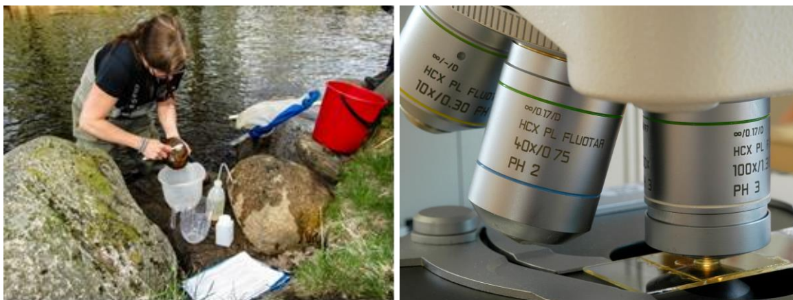
Figur 29. Provtagning av kiselalger görs i första hand genom borstning av stenar varefter kiselalgspreparat framställs och analyseras i ljusmikroskop med 1000 gångers förstoring (objektiv 100x), © Sweco Sverige AB.
